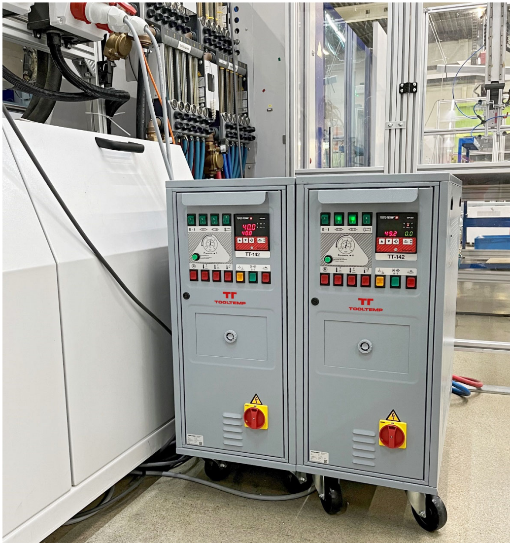
Tool-Temp Druckwasser-Temperiergeräte TT-142 N im Einsatz bei der Stüdi Plast AG
